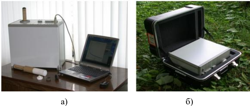
Рисунок 2.3 – Внешний вид ЯМР-релаксометра «МСТ-05» в рабочем состоянии (а) и при транспортировке (б)
